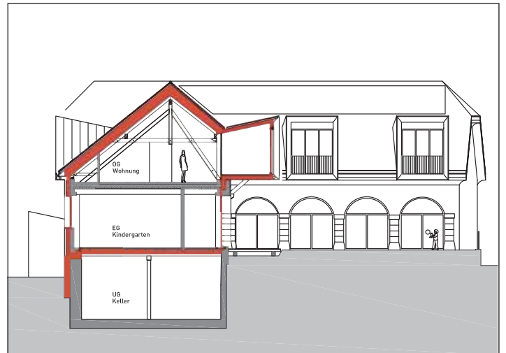
Abbildung 159: Lückenlose Wärme- dämmung.
